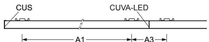
**MÉCANIQUE****Couleur du boîtier** blanc signalisation RAL 9016**Cotes (Long.xLarg.xH/DxH)** 1179mm x 161mm x 54mm**Poids (net)** 3.3kg**Entrée de câble KE (X/Y)** 0mm/56mm**Type de montage** Montage individuel en saillie au plafond,
